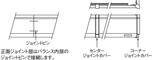
正面ジョイント部はバランス内部のジョイントピンで接続します。
