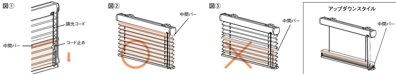
※図はツインスタイル・ループコード式の場合です。ツインスタイル・アップダウンスタイルはコード式・ループコード式・チェーン式すべてコード切れなどの故障の原因となりますので、必ず中間バーを一番上に上げた状態でスクリーンを上げてください。ワンチェーン式の場合、上部スクリーンがたたみ込まれていない状態でスクリーン全体を上げると、上部スクリーンも同時に上がるため、操作が重くなることにより故障の原因となります。
