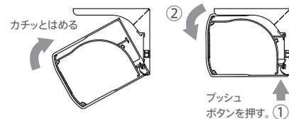
取付けは、ロールカバーの下側をブラケットに差し込み、さらに上側をはめ込みます。取外しは、下面のプッシュボタンを押すことで簡単に取外すことができます。
