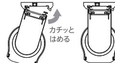
セットフレームの手前側をブラケットに差し込み、さらに窓側(奥側)をはめ込みます。
