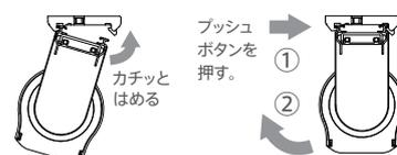
セットフレームの手前側をブラケットに差し込み、さらに窓側(奥側)をはめ込みます。取外しは、手前のプッシュボタンを押すことで簡単に取外すことができます。
