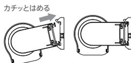
セットフレームの下側をブラケットに差し込み、さらに上側をはめ込みます。
